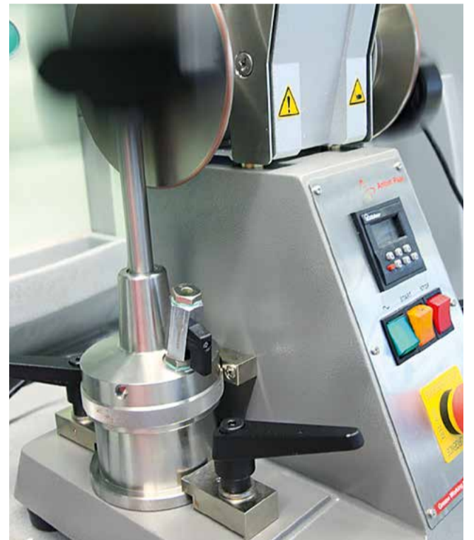
Grease Worker | DIN ISO 2137 Im Grease Worker wird die Walkpenetration regulär nach 60 Doppeltakten und die verlängerte Walkpenetration nach 5.000 bis 100.000 Doppeltakten bestimmt. Je geringer die Abweichung zwischen Ruh- und Walkpenetration, desto stabiler verhält sich das Fett bei mechanischer Bearbeitung.
