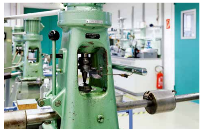
Vierkugelapparat | DIN 51350/1-6 Der Vierkugelapparat dient zur Beurteilung der Schmierfähigkeit bei hoher Druckbelastung oder unter Verschleißbeanspruchung. Je nach eingestellter Prüfkraft tritt entweder ein Verschweißen der Kugeln ein oder die obere Kugel hinterlässt Verschleißmarken auf den unteren Kugeln. Die Schweißkraft oder die Größe der Verschleißmarken sind Kriterien zur Beurteilung des Leistungsvermögens eines Schmierstoffes während der Entwicklung.
