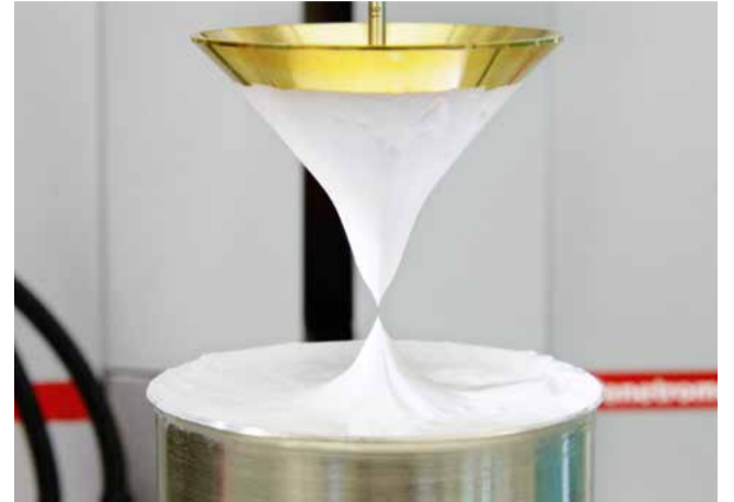
Penetrometer | DIN ISO 2137/ASTM D217 bzw. ASTM D1403 Die Ruhpenetration bezeichnet die Penetration einer Schmierfettprobe bei 25 °C, die vorher nicht gewalzt wurde. Je höher die Eindringtiefe des Prüfkonus, um so höher die Penetrationszahl, um so weicher ist das Schmierfett und um so niedriger die Konsistenzklasse nach NLGI.
